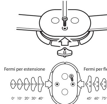
Con il supporto vengono forniti i fermi sia per la flessione che per l'estensione. Il supporto è dotato dei fermi di estensione a 10° già installati. I fermi sono muniti di etichetta con la dicitura in gradi di questo tipo:
