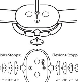
Sowohl die Flexions- als auch die Extensions-Stops werden mit der Schiene mitgeliefert. Die Stütze wird mit einem bereits installiertem 10 Grad-Extensions-Stopp geliefert. Die Stopp sind mit den folgenden Gradbezeichnungen versehen;
