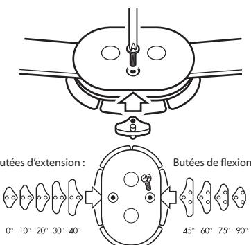
Les butées de flexion et d'extension sont fournies avec l'orthèse. L'orthèse est munie d'une butée d'extension de 10° déjà mise en place. Les butées sont indiquées en degrés comme suit :
